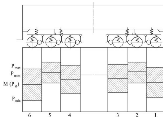
Рис. 4. Статические характеристики распределения нагрузок от колесных пар на рельсы
