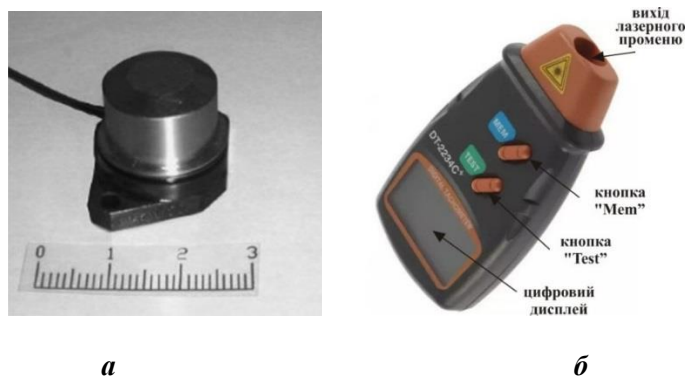
Рис. 2. Загальний вид датчика АНС-014 (а) і лазерного безконтактного тахометра DT2234C (б)
