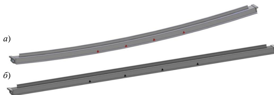
Рис. 3. Балка хребтова зі зварним швом до процедури термічної правки (а) та після (б)
