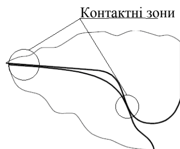
Рис. 4. Схеми двоточкового контакту
