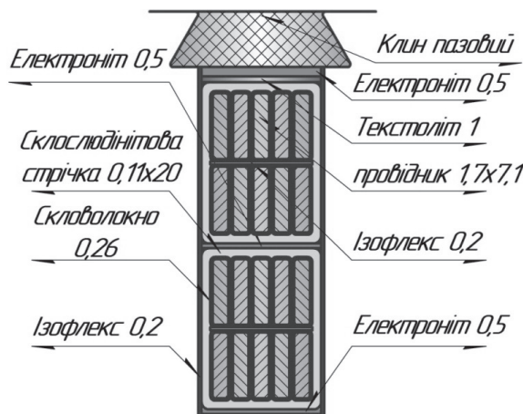
Рис. 1. Система ізоляції пазової частини катушок якоря РТ-51Д
