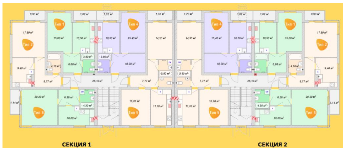
Рис. 11. План поверху будівли
