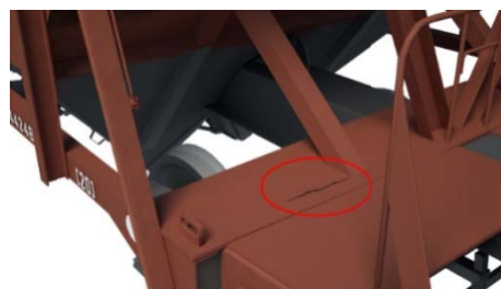
е) Поздовжні тріщини в балках рами
