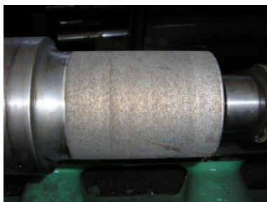
Рис. 5. Відновлена шийка осі колісної пари
