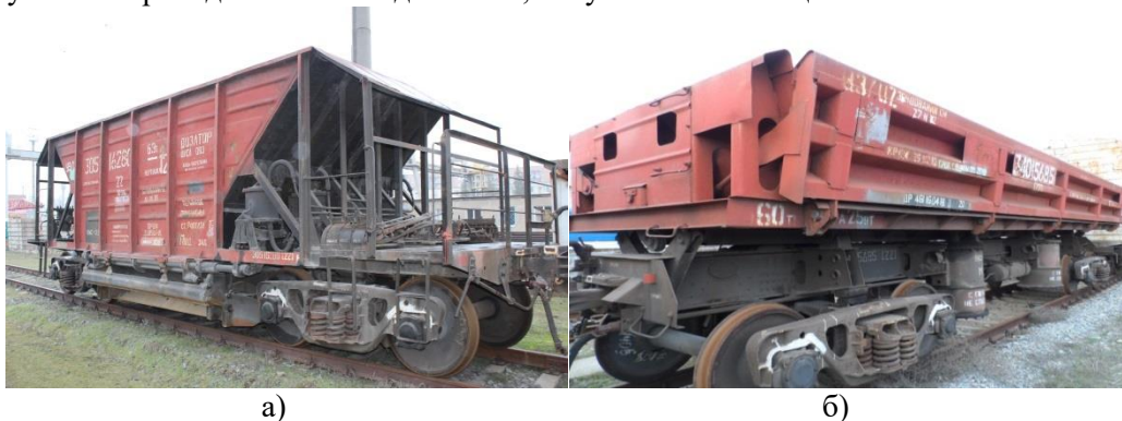
Рис. 1. Загальний вигляд вантажного вагона: а) хопер-дозатор; б) думпкар (самоскид)
