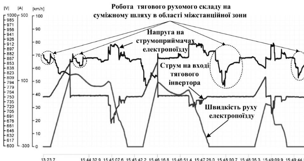
Рис. 6. Осцилограми роботи електропоїзду на одній із ліній Харківського метрополітену
