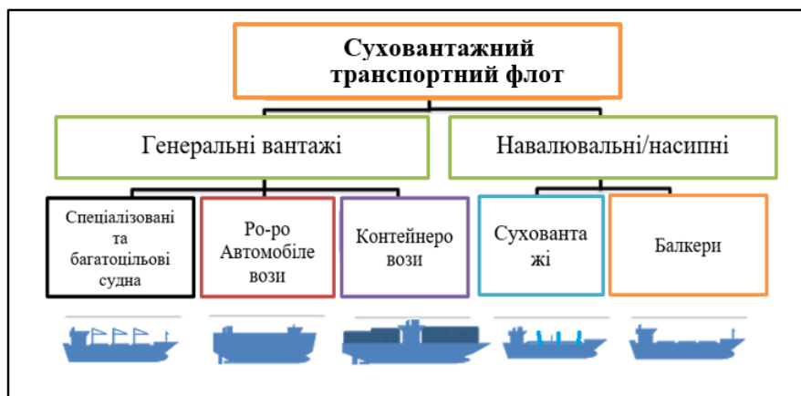
Рис. 8. Класифікація суден суховантажного транспортного флоту
