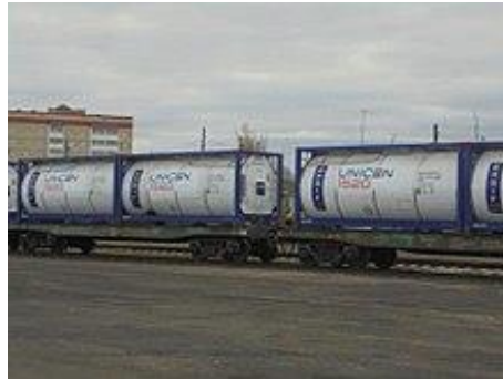
Рис. 4. Контейнери – цистерни, встановлені на залізничну платформу
