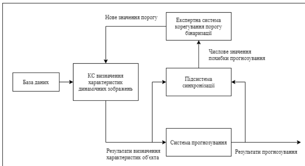
Рис. 1. Структурна схема імітатора комп'ютеризованої системи (КС) обробки та прогнозування трас лазерних пучків
