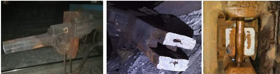
Рис. 3. Обрив корпусу автозчепу СА-3 по отвору для клина тягового хомута
