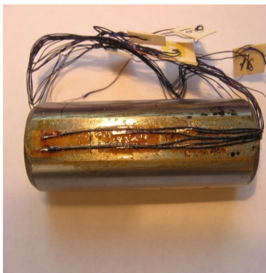
Рис. 1. Вісь сателіта з тензорезисторами
