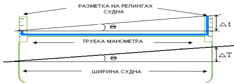
Рис. 1. Принцип действия жидкостного манометра
