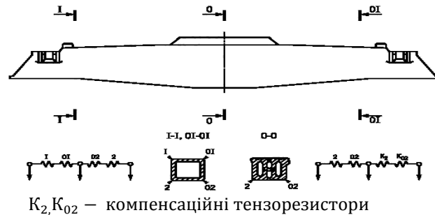
Рис. 4. Схема установки і з'єднання тензорезисторів для визначення коефіцієнтів вертикальної динаміки в перетинах надресорної балки візка вантажного вагона
