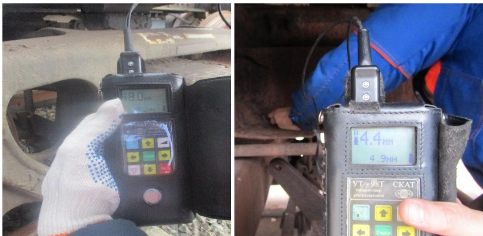
Рис. 4. Приклад вимірювання товщини УТ методом металевих конструкцій вантажних вагонів
