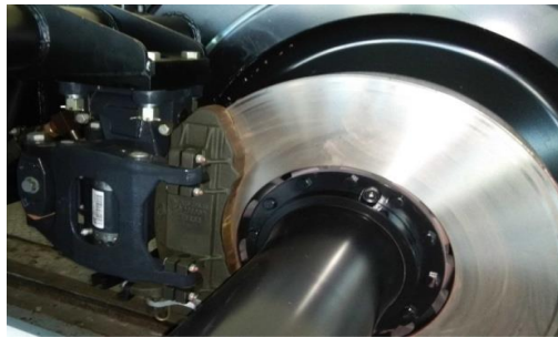
Рис. 1. Дисковый тормоз, установленный на оси колесной пары
