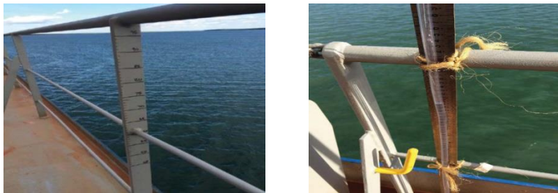
Рис. 2. Разметка стоек бортовых релингов и крепление трубок жидкостного манометра
