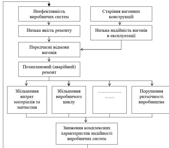
Рис. 1. Схема деградаційних процесів у виробничих системах
