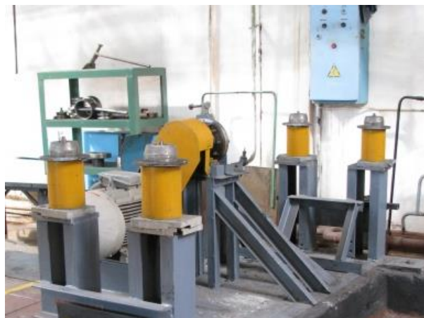
Рис. 10. Стенд для випробувань редукторів в електродепо «Кіровське»
