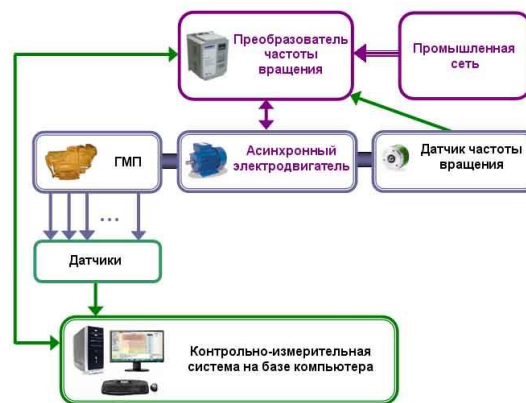
Рис. 4. Принципова схема функціонування та управління стендом ОТС-6
