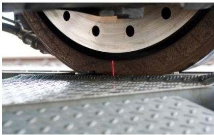
Рис.3. Робота лазерних датчиків контролю системи «ARGUS II»
