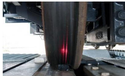
Рис.3. Робота лазерних датчиків контролю системи «ARGUS II»
