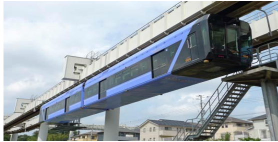
Рис. 7. Монорельсовая система SAFEGE, город Тиба, Япония 21
