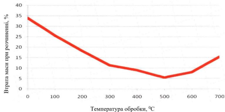
Рис. 2. Втрата маси при розчиненні залежно від температурної обробки після витримання в лужному середовищі протягом 28 діб
