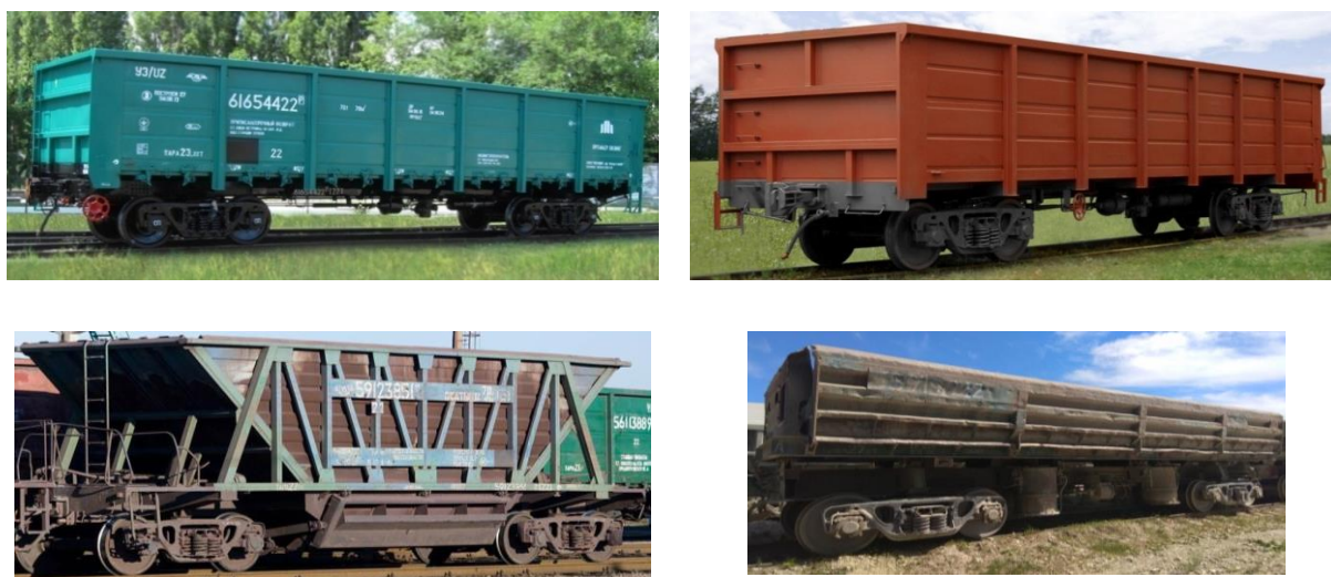
Рис. 1. Тип вантажного рухомого складу для перевезення залізрудних окатишів, який використовується ПАТ «Полтавський гірничо-збагачувальний комбінат»
