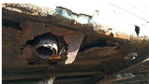
Рис. 6. Корозійні пошкодження підлоги кузова
