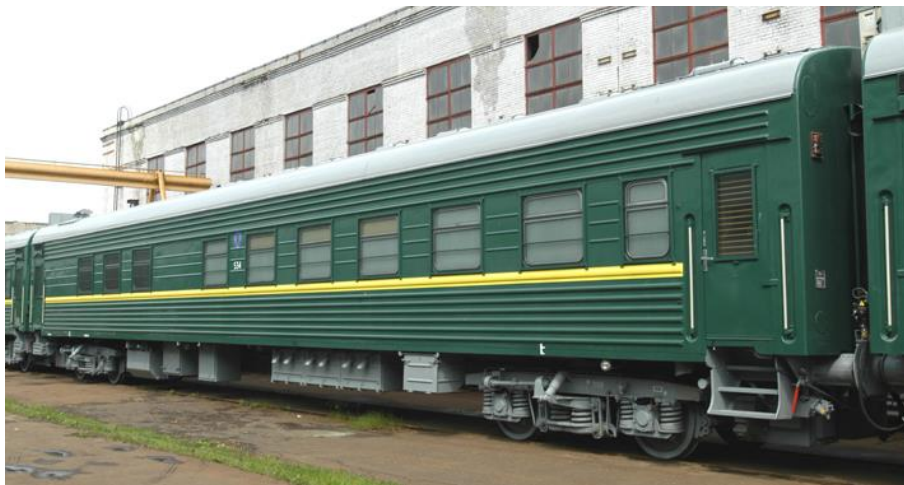
Рис. 1. Вагон спеціального призначення моделі 61-4500 (для перевезення спецконтингенту)
