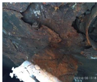
Рис. 3. Корозійні пошкодження кузова (зона 1 – підлога кузова)
