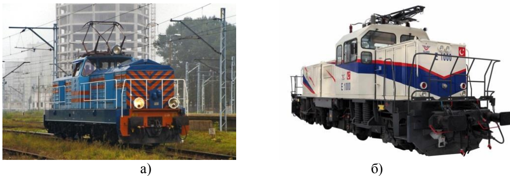
Рис. 4. Маневрові електровози а – маневровий електровоз EM10; б – маневровий електровоз E1000
