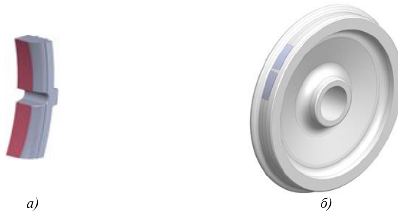
Рис. 4. Моделювання навантаження колеса під час гальмування а) робоча поверхня колодки; б) розміщення накладок на колесі
