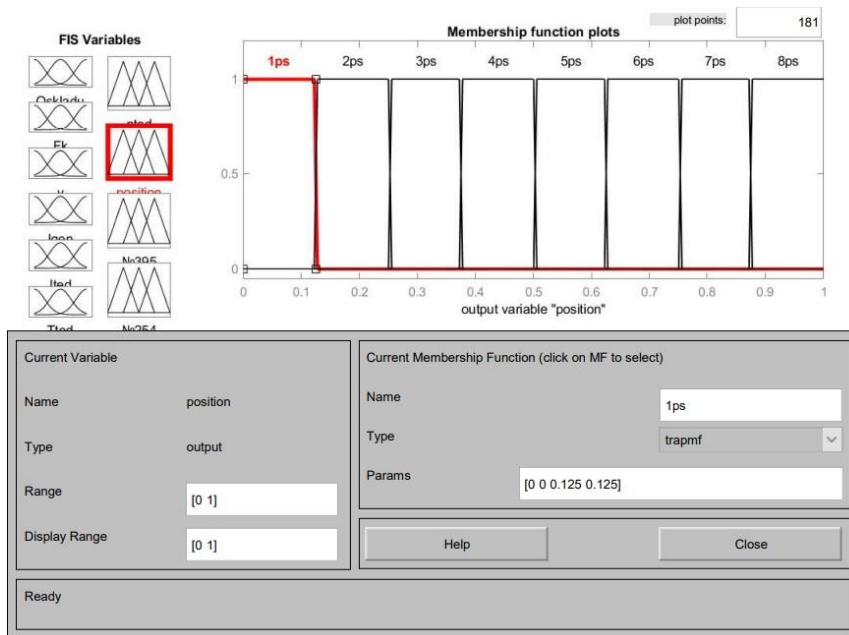
Fig. 8. Fuzzification of the «Operator's controller handle position» value
